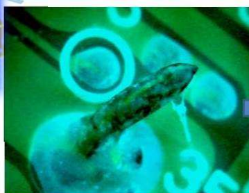
溶剤系防湿絶縁材を原液(400CPS)にて 部分塗布 乾燥膜厚30μ
