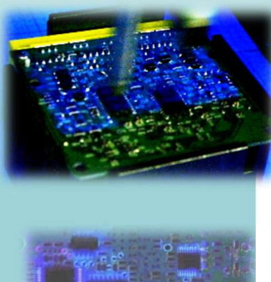
溶剤系防湿絶縁材を原液(400CPS)にて 部分塗布 乾燥膜厚30μ
